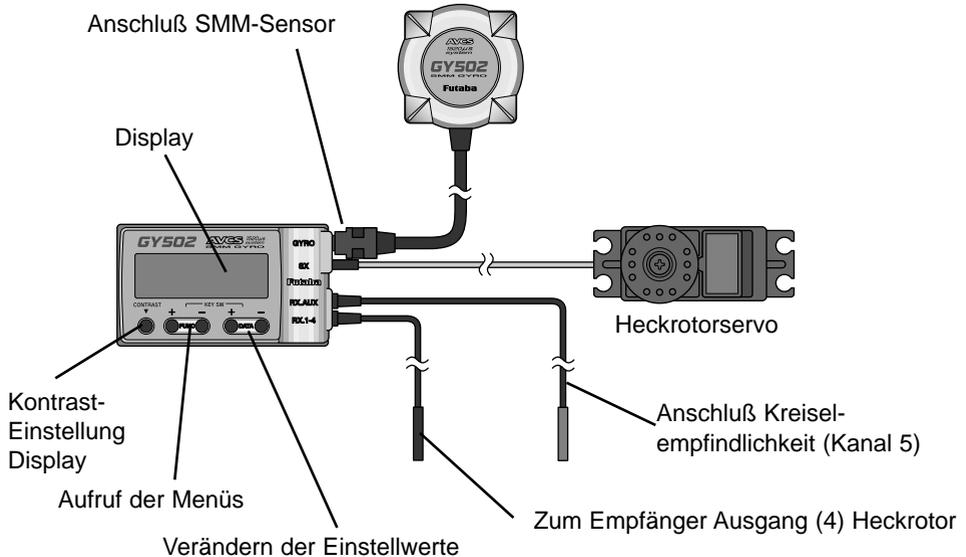
**6. Einbau und Anschluß des GY502:**
